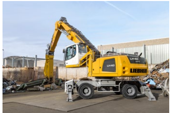
LH 40 M Industry Litronic beim Zerlegen von Stahlträgern mit einer Schrottschere
