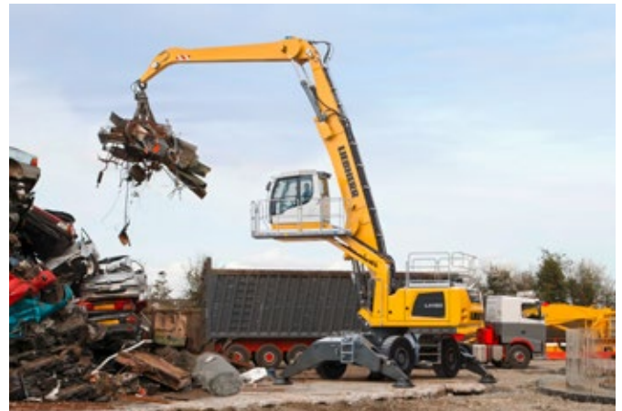
Schrottverladung mit dem LH 50 M Industry Litronic
