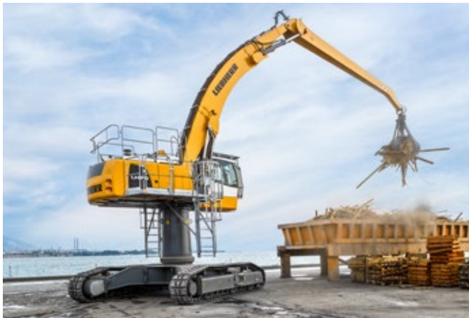
LH 50 C High Rise Industry Litronic beim Verladen von Holzabfällen
