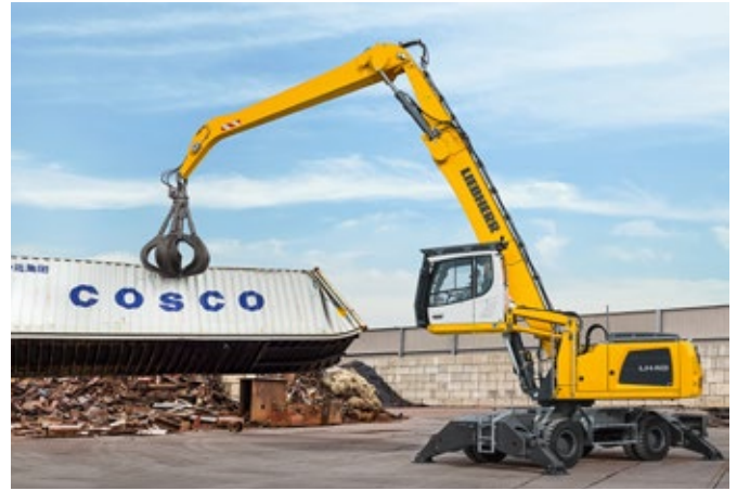
Containerzerlegung mit dem LH 40 M Industry Litronic
