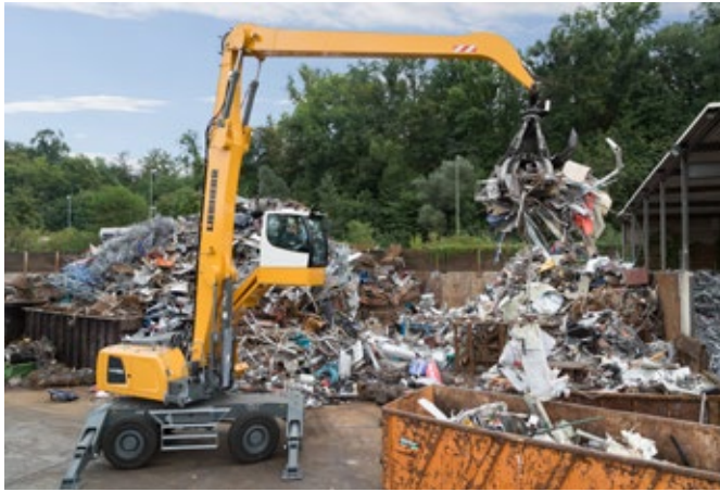
LH 50 M Industry Litronic bei der Schrottverladung
