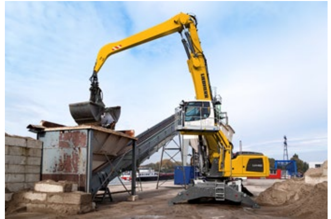
Beschickung einer Betonmischanlage mit dem LH 40 M Industry Litronic
