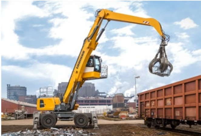
Waggonbeladung von gepressten Aluminiumpaketen mit dem LH 50 M Industry Litronic
